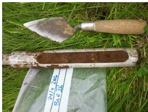
Mynd 1. Borinn sem notaður var við sýnatökuna (mynd: höfundur).
